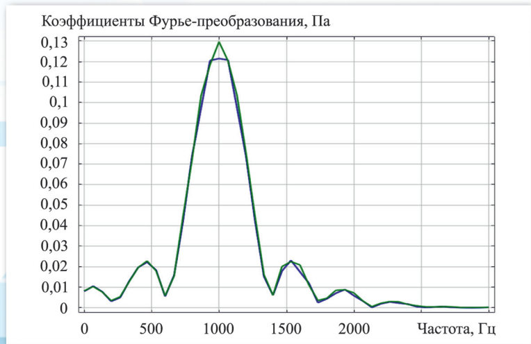
Рис. 4. Генерируемый импульс на частоте f_0 = 1000 Гц Fig. 4. Pulse generated at frequency f_0 = 1000 Hz
