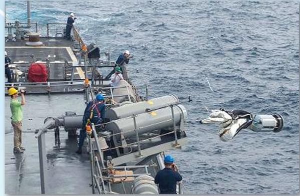
**Рис. 6.** Надувная радиолокационная ложная цель DLF-3B (Мк 59) на воде и ее пуск с эсминца США Ramage. 2014 г.
