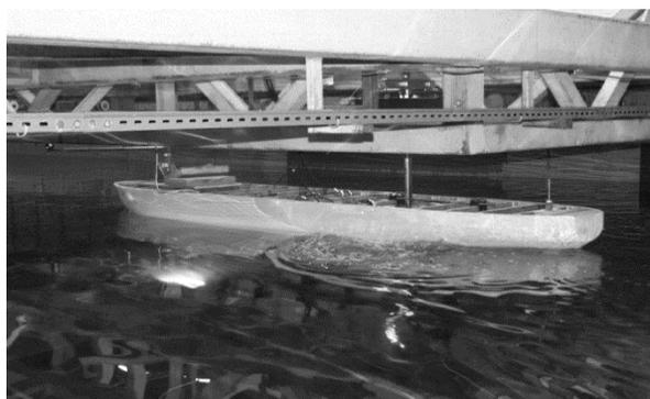
**Рис. 2.** Буксировочные испытания модели. Реверсирование гребных винтов. Передний ход
