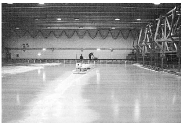
Рис. 7. Испытания по буксировке модели в сжатых льдах в бассейне Университета Аалто [36]
