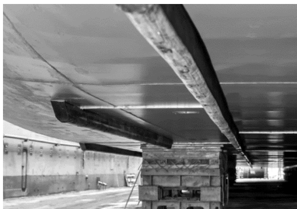
Рис. 7. Днище судна с установленными продольными килями и поперечными кавитаторами [21]
