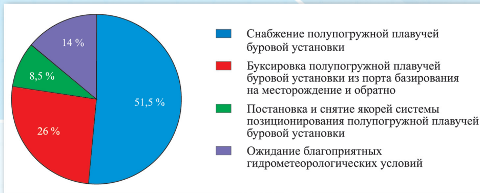
Рис. 10. Распределение времени операций многоцелевого судна обеспечения при обслуживании полупогружной плавучей буровой установки [1]
