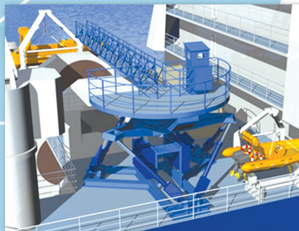
Рис. 17. Пример установки пересадочного устройства типа Ampelmann (модель А) на палубе надстройки первого яруса многоцелевого судна обеспечения [9]
