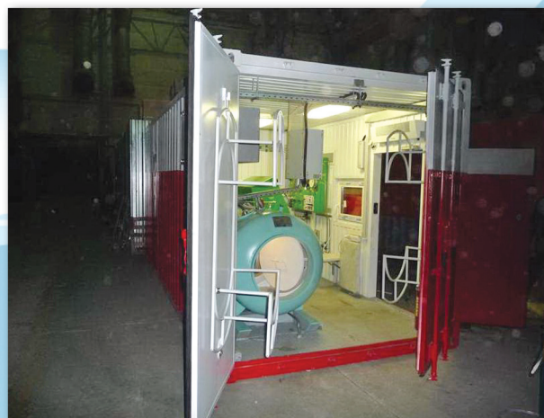
Рис. 16. Общий вид мобильного водолазного комплекса в контейнерном исполнении производства ООО «Дайвтехносервис» [8]
