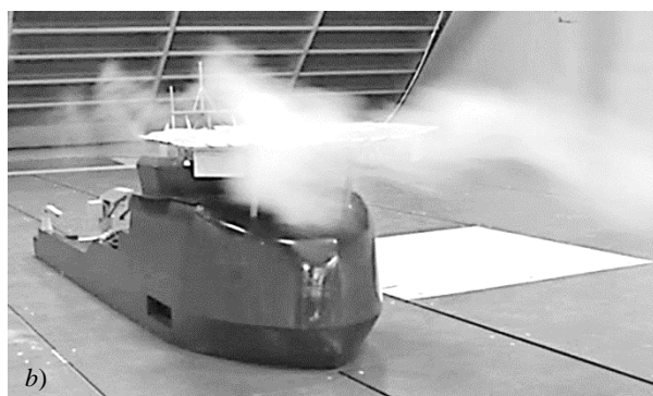
Рис. 9. Фрагменты испытаний модели многоцелевого судна обеспечения в аэродинамической трубе Крыловского центра [1]: а) модель надводной части корпуса при испытаниях; б) обдув вертолетной площадки
