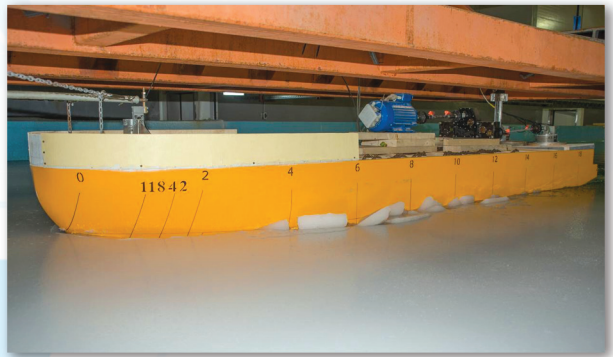
Рис. 5. Фрагмент испытаний модели многоцелевого судна обеспечения на стендах Крыловского центра [1]: a) в гидродинамическом бассейне; b) в ледовом бассейне
