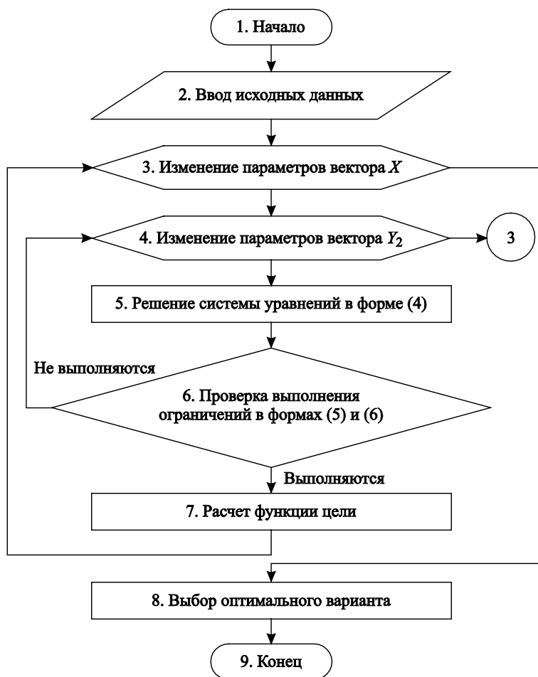
Рис. 1. Блок-схема оптимизации главных размерений грузового судна с интервальной неопределенностью параметров
