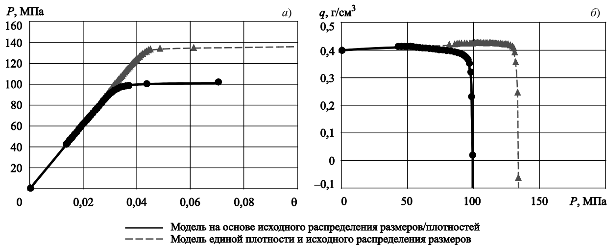
Рис. 5. Сравнение диаграмм нагружения для сферопластика; диаграммы деформирования \theta (а) и плавучести q (б) с ростом давления P
