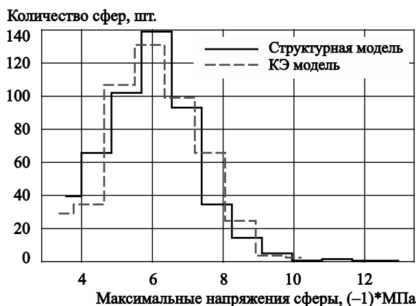
Рис. 1. Сравнение распределений напряжений для конечно-элементной и структурной моделей
