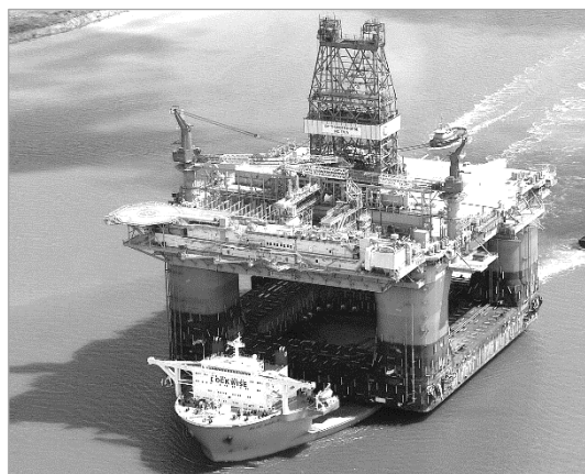
Рис. 4. Транспортировка полупогружной буровой установки на полупогружном судне
