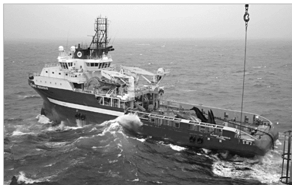
Рис. 3. Буксир-завозчик якорей (Anchor Handling Tug Supply Vessel)
