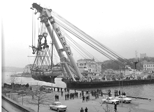
Рис. 1. Плавкран «Витязь» полной грузоподъемностью 1600 т
