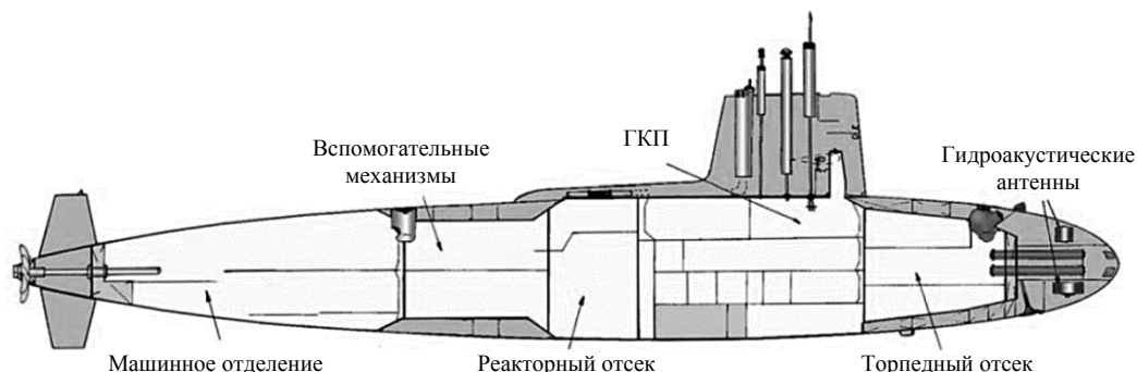
Рис. 2. Схема атомной подводной лодки США типа «Скипджек» Fig. 2. Layout of Skipjack -class SSN (USA)
