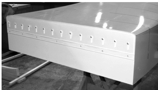
Рис. 3. Транец модели 1 с установленным интерцептором
