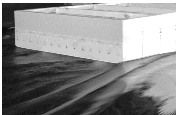
Рис. 10. Обтекание транца модели 1 Fig. 10. Flow pattern around Model 1 transom
