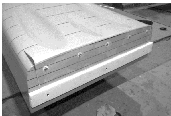
Рис. 5. Кормовая оконечность модели 2 с транцевым интерцептором и ограничительными килями
