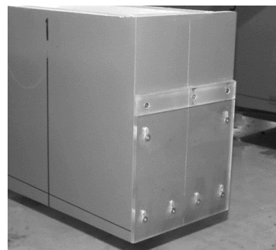
Рис. 8. Транец одного корпуса модели катамарана с установленным интерцептором
