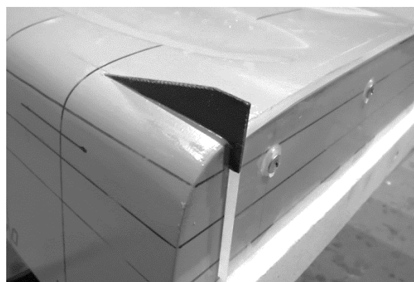
Рис. 5. Кормовая оконечность модели 2 с транцевым интерцептором и ограничительными килями
