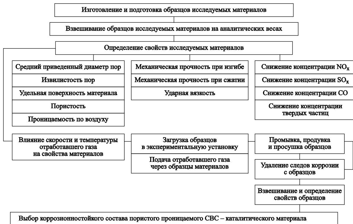
Рис. 1. Методика проведения экспериментальных исследований по изучению влияния газотермической коррозии на свойства и характеристики пористого проницаемого каталитического материала
