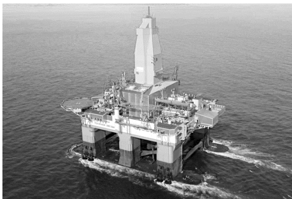
Рис. 2. Полупогружная плавучая буровая установка «Полярная звезда» [9]
