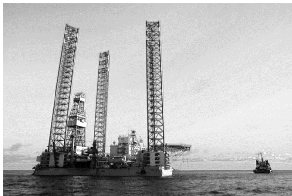
Рис. 3. Самоподъемная буровая установка «Арктическая» с выдвигаемыми опорами [10]
