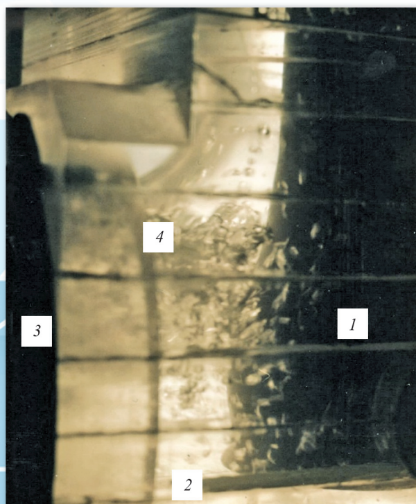
Рис. 19. Активная пузырьковая область, пополняемая аэрированным потоком со стороны межпонтонной магистрали со скоростью порядка 1 м/с и вовлекаемая в насос: 1 – корпус насоса; 2 – насосная камера; 3 – фланец сопряжения с межпонтонной магистралью; 4 – пузырьковая пульсирующая область и вихрь
