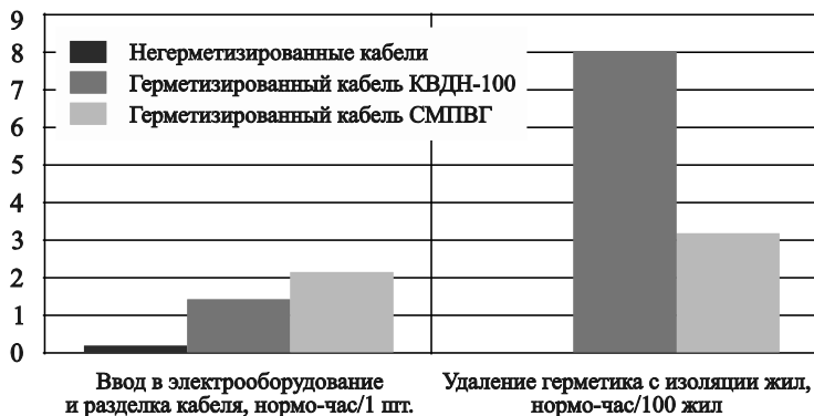
Рис. 4. Сравнительный анализ затрат труда на выполнение технологических операций по вводу в электрооборудование и разделке негерметизированных и герметизированных кабелей
