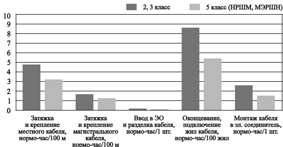
Рис. 1. Сравнительный анализ затрат труда на выполнение комплекса судовых электромонтажных работ гибких и стандартных кабелей
