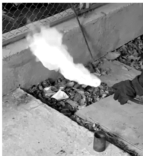
Рис. 10. Горение парогазовой смеси, выделяемой литий-ионным аккумулятором на основе литий-железа фосфата при тепловом разгоне
