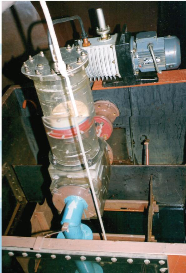
**Рис. 6.** Макет вакуумного сепарационного устройства, смонтированный на рабочем участке гидравлического стенда
