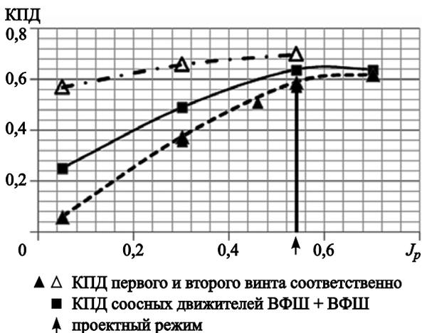
**Рис. 7.** Изменение КПД соосного движителя ВФШ + ВФШ и отдельно входящих в него элементов. Соосный движитель спроектирован на умеренную нагрузку
