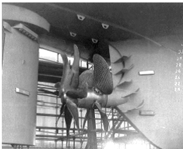
Рис. 3. Колесо Грима. На фото также видна система крыльев, которые спрямляют поток, натекающий на винт [8]
