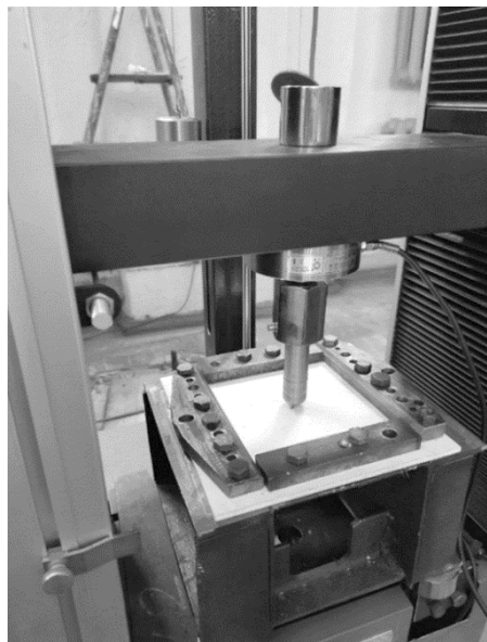
Рис. 13. Проведение испытаний пластины на изгиб
