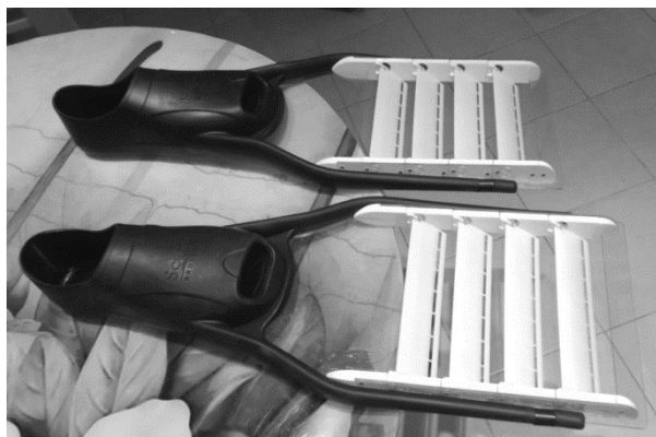
Рис. 10. Внешний вид экспериментальных ласт с самостабилизирующимися лопастями
