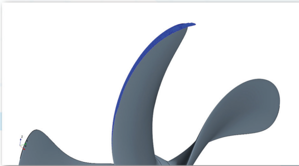
Рис. 14. Область с давлением ниже давления насыщенных паров на лопасти в однородном потоке. Режим 4: J = 0,5582 , \sigma_n = 1,835
