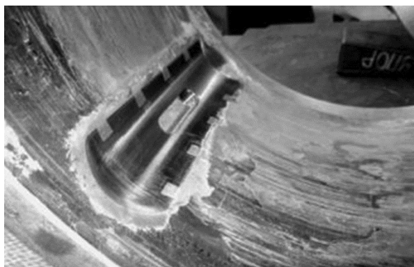
Рис. 1. Механические повреждения рабочих поверхностей в подшипниках входного вала
