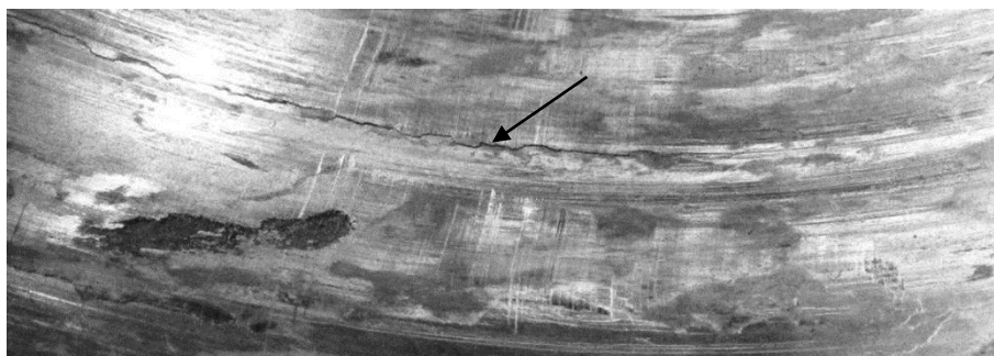
Рис. 2. Окружная трещина на поверхности подшипника после длительных испытаний
