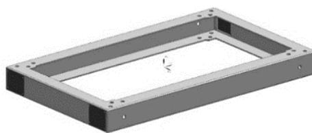
Рис. 2. Схема сварного металлического цоколя
