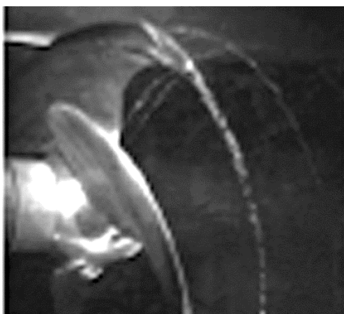
Рис. 14. Картина образования концевое вихря на лопасти с большим skew (конец лопасти полностью охвачен концевым вихрем). Фото [10]
