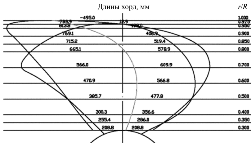
Рис. 18. Контур лопасти альтернативного винта Крыловского центра
