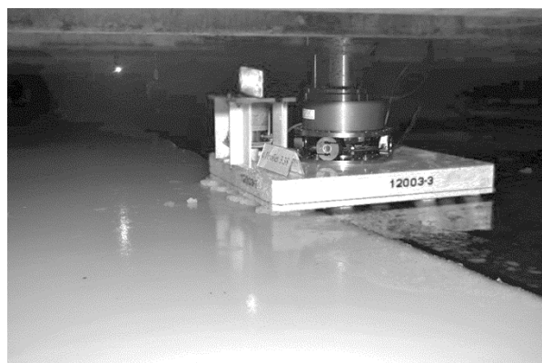
Рис. 1. Эксперимент по торможению льдины моделью морского гидротехнического сооружения Fig. 1. Experiment of ice floe being checked by marine hydraulic structure
