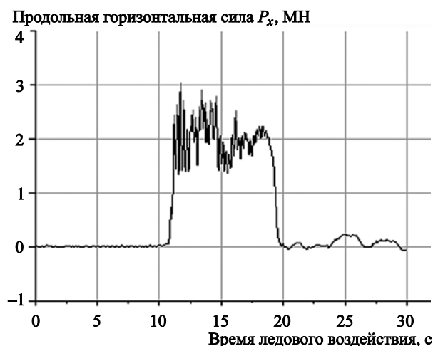
Рис. 2. Типичный результат измерения силы взаимодействия останавливавшейся льдины с моделью сооружения
