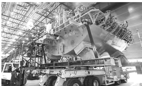
Рис. 12. Секция изолированной палубной конструкции (вид снизу)
