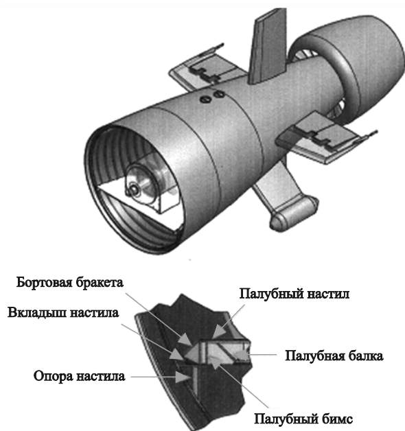
Рис. 5. кормовой участок корпуса с виброизолированной платформой, на которой размещены редуктор и упорный подшипник атомной подводной лодки типа Virginia
