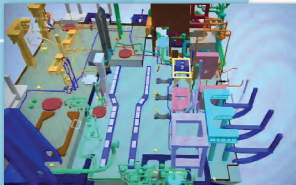
Рис. 11. Участок объемной рамы третьей палубы второго отсека с фундаментами оборудования
