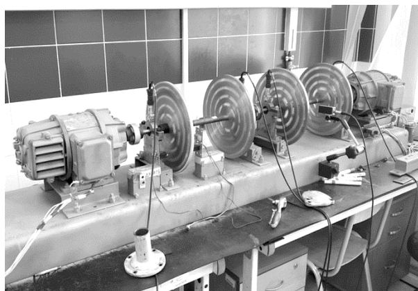
Рис. 1. Экспериментальный стенд для исследования вибрационных характеристик судовых машин
