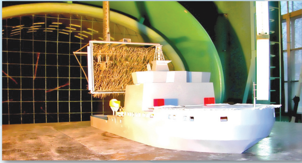
Рис. 1. Общий вид модели ледокола. Точки измерения местных скоростей над взлетно-посадочной площадкой [4] Fig. 1. General view of the icebreaker model. Measurement points of local velocities over helipad [4]
