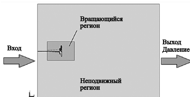
Рис. 2. Схема расчетной области для задачи моделирования работы гребного винта KP505
