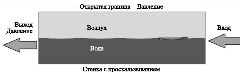
Рис. 14. Схема расчетной области для задачи качки судна KCS на встречном волнении
