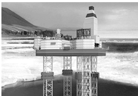
Рис. 22. Ледостойкая самоподъемная буровая установка для глубин до 120 м [12]
