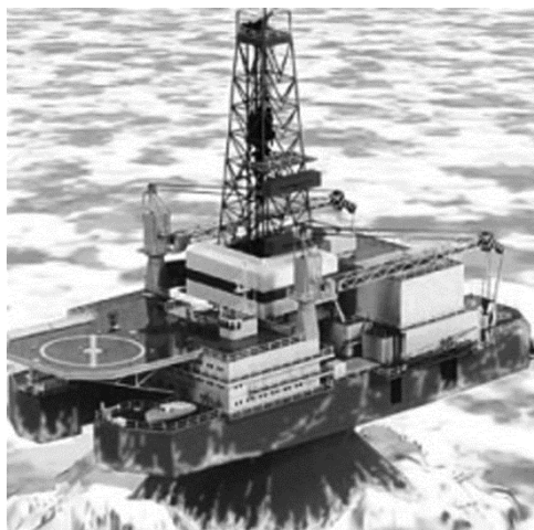
Рис. 11. Мобильная ледостойкая буровая установка «Нерпа» для глубин 7–27 м [10]
