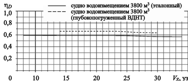
Рис. 10. Зависимость пропульсивного коэффициента \eta_D от скорости V_S быстроходного судна водоизмещением 3800 \text{ м}^3
