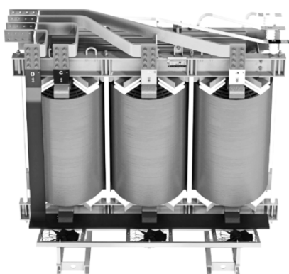
Рис. 9. Изображение преобразовательного трансформатора ТСП-2000/6-УЗ мощностью 2,0 МВА с многослойными катушечными обмотками и изоляцией (воздушно-барьерного монолита), обладающего перегрузочной способностью до 200 % в диапазоне температур от +40 до -60 °С и более высокой стойкостью к динамическим усилиям при токах короткого замыкания
