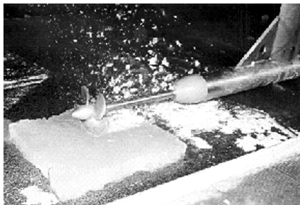
Рис. 1. Фрезерование куска льда с помощью установки свободной воды
