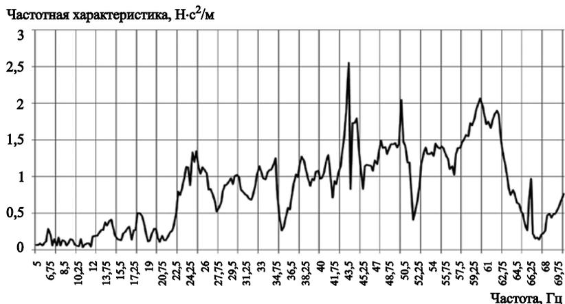
**Рис. 8.** Частотная характеристика перекрытия тренажерного зала
