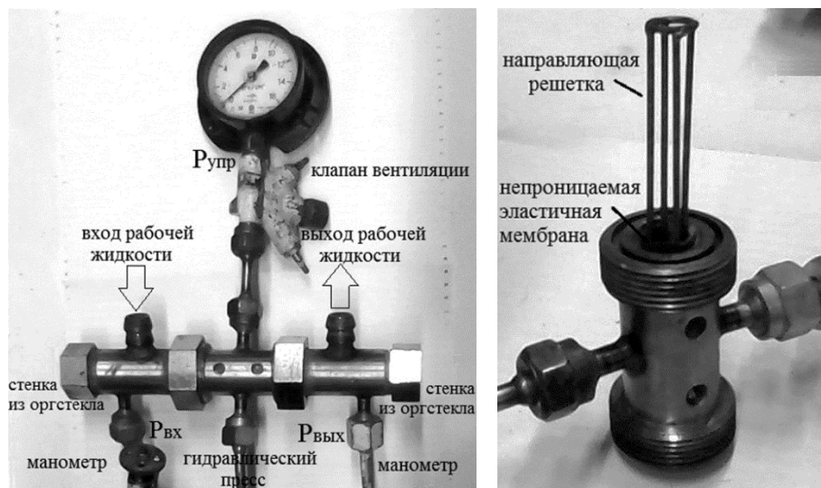
Рис. 3. Общий вид макета регулируемого дроссельного устройства в сборе и с разобранной внутренней частью Fig. 3. General view of adjustable throttle model fully assembled and without the inner part
